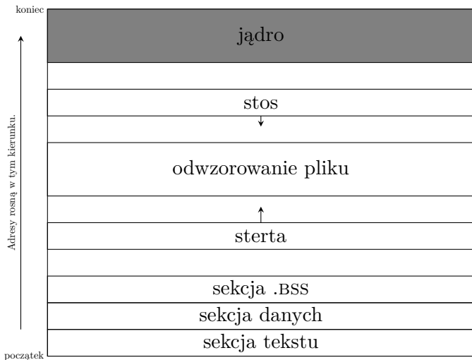
Rysunek 1: Uproszczony model przestrzeni adresowej w Linuksie
